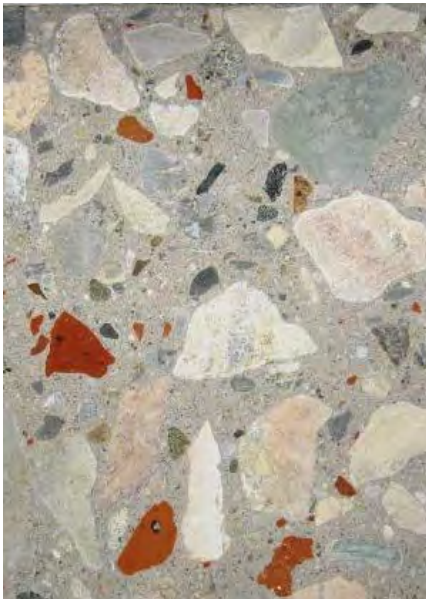
Schnitt durch einen R-Beton.
