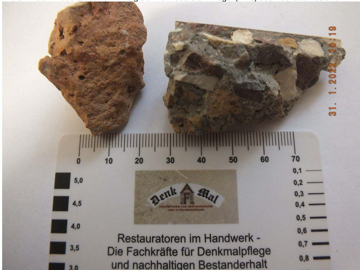
Bild 8: Detail Probe 3/ rechts im Vergleich zu Mauerstein Ziegel (links) aus Rückbau Bestand
