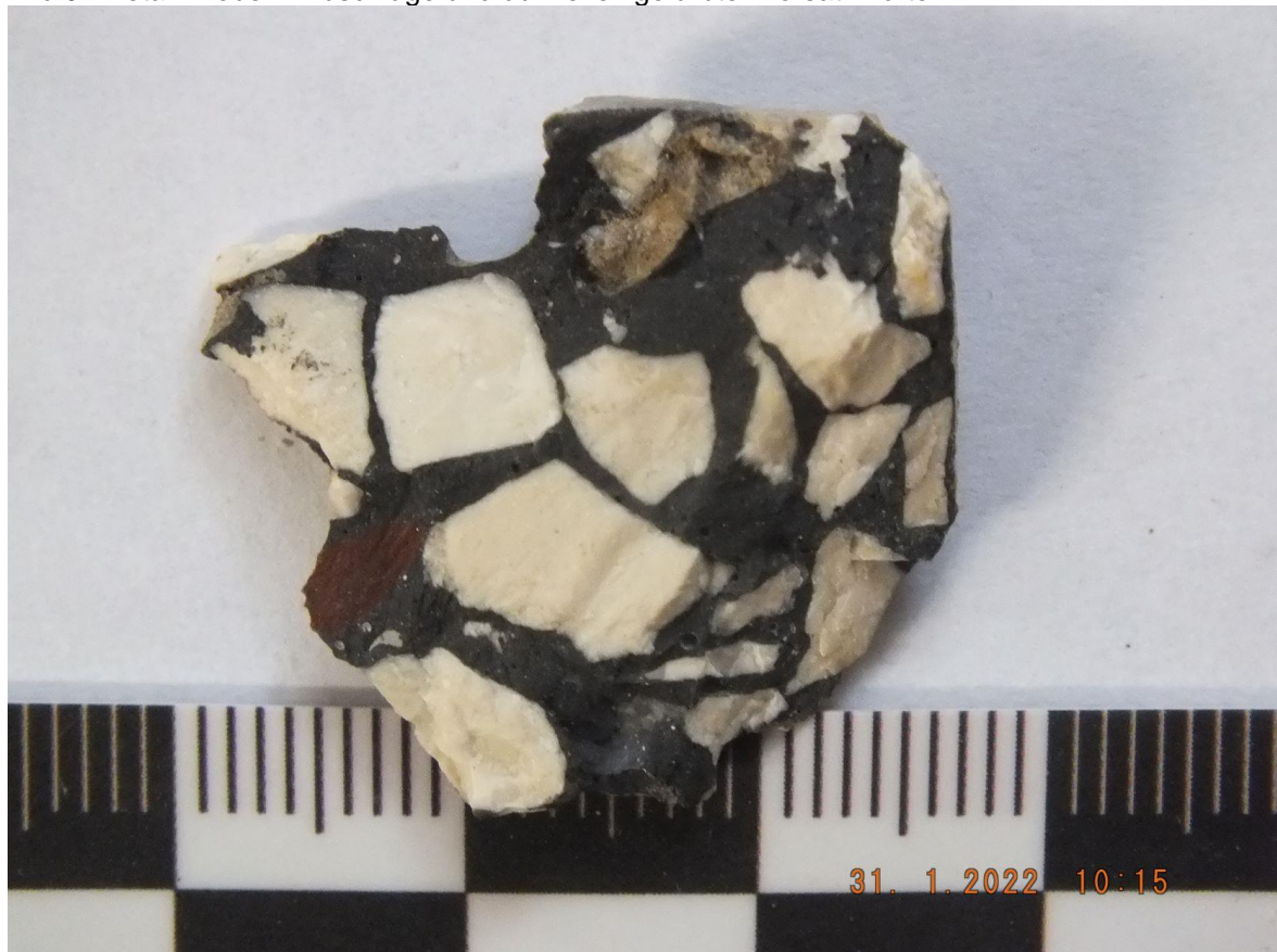
Bild 9: Detail Probe 1: Zuschläge und dunkel eingefärbter Vorsatzmörtel
