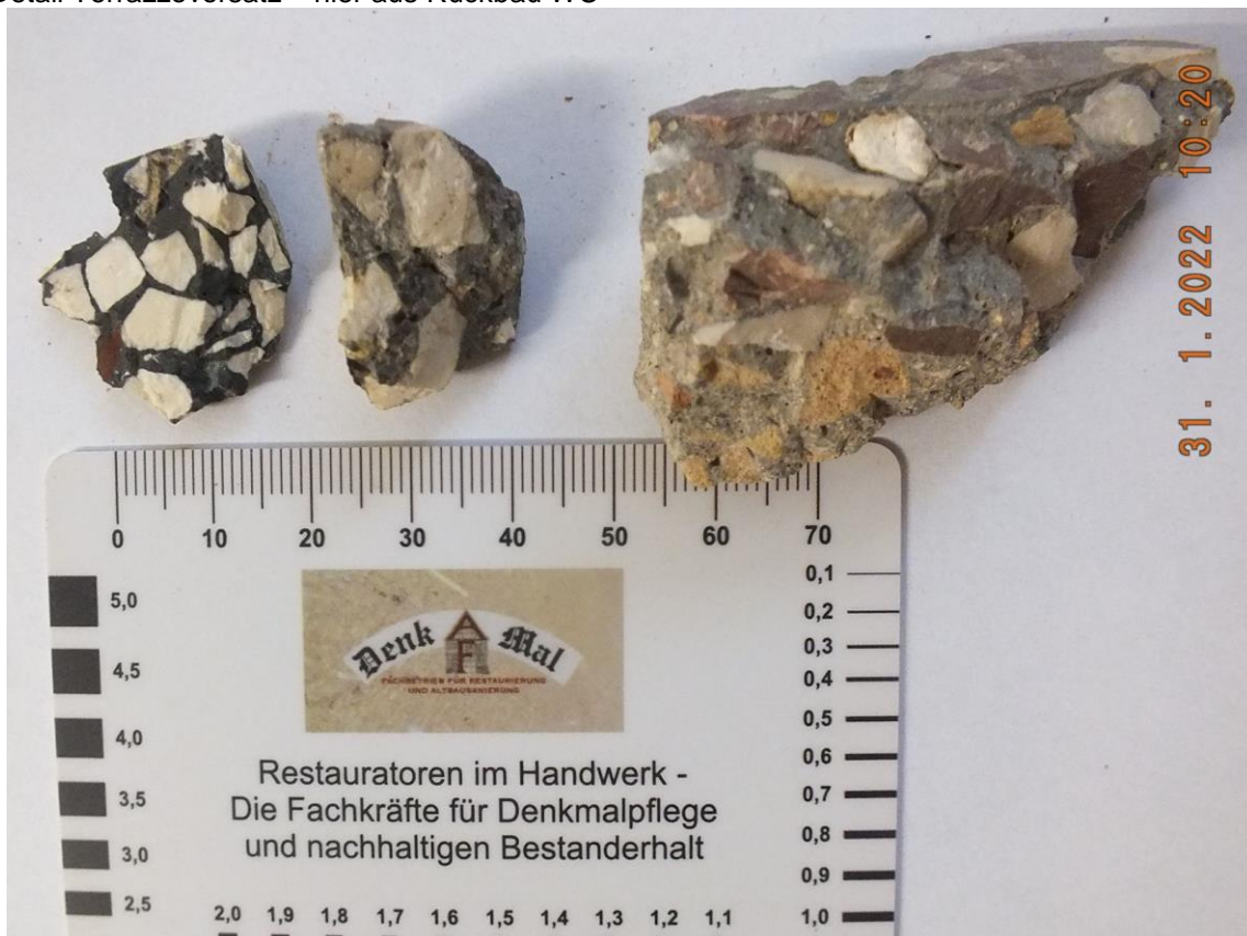
Bild 7: Detail der einzelnen Proben (von links nach rechts P1/P2/P3) / Aufbau, Zuschläge und Detail Terrazzovorsatz – hier aus Rückbau WC
